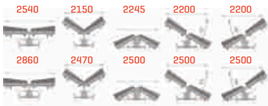
Schemat pracy pługa odsnieżnego PDZ 24 i PDZ 28
